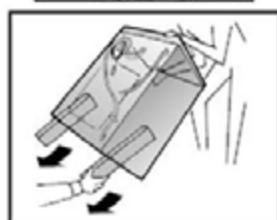
Поставьте крышку на место, двигая ее в горизонтальном направлении вперед и закрепите ее винтами **A**.
