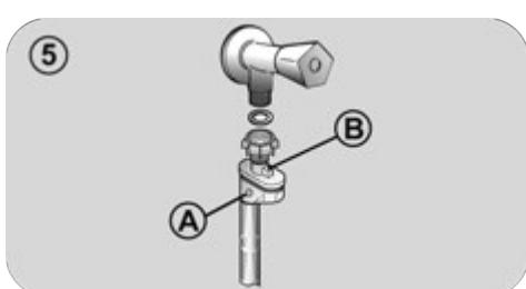
● **AQUAPROTECT - (ЗАЩИТА ПОДАЧИ ВОДЫ) – ШЛАНГ ПОДАЧИ ВОДЫ С ОБОЛОЧКОЙ** (рис. 6): При наличии утечки воды из основного внутреннего шланга "A", в прозрачной оболочке шланга "B" будет скапливаться вода, позволяющая завершить цикл стирки. После окончания цикла стирки свяжитесь с сервисным центром для того, чтобы заменить шланг подачи воды.
