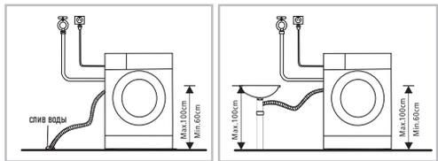
**ПРИМЕЧАНИЕ:** если конец сливного шланга выведен в раковину, как и в случае с выводом в ванную, используйте специальный держатель (кронштейн, скобу), а также надежно закрепите держатель с помощью цепочки или веревки.
