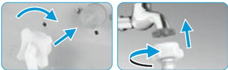
1. Проверьте наличие резиновых прокладок на обеих сторонах заливного шланга. При необходимости вставьте резиновые прокладки в резьбовые фитинги каждого шланга для обеспечения герметичности.
