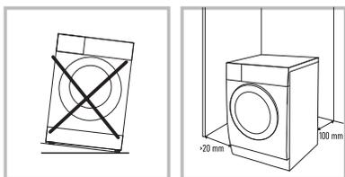
1. Поверхность, на которую стиральная машина будет установлена, должна быть сухой, ровной и твердой.
