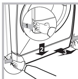
1. снимите переднюю панель стиральной машины, нажав в центре, затем потяните ее вниз за края и снимите ее (см. схему).
