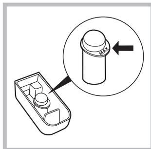
шерстяных тканей. Лоток 4 для отбеливателя вставляется в отделение 1 распределителя моющих средств. Не заполняйте лоток 4 выше отметки max (см. рис.). Для осуществления только отбеливания налейте отбеливатель
