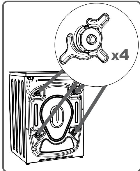
Для этого транспортировочные предохранительные болты необходимо ослабить путем поворота против часовой стрелки с помощью подходящего гаечного ключа.
