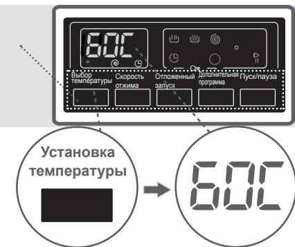
Вы можете постепенно снижать температуру воды с максимальной до холодной (--), нажимая на кнопку регулировки температуры воды.
