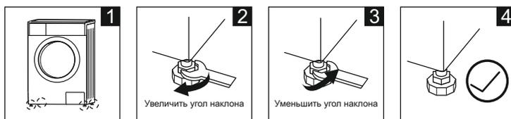
При необходимости отрегулируйте высоту ножек для компенсирования неровности пола, немного наклонив ее и поворачивая ножки.
