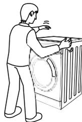
4. Нажмите на ножки с одной стороны и закрепите гайку плотно с другой стороны.
