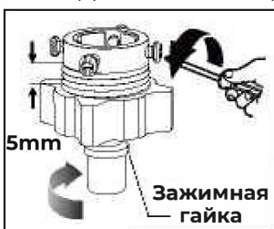
Ослабьте зажимную гайку и все 4 болта
