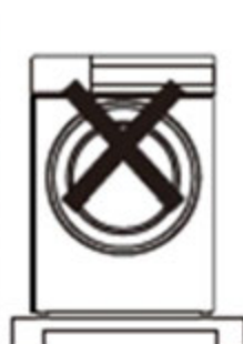
Установка на кронштейн
