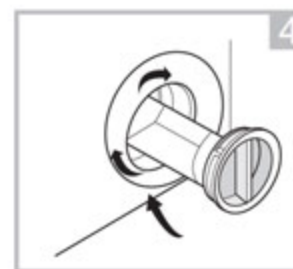
Установите фильтр на место, повернув по часовой стрелке, закройте крышку сервисного люка
