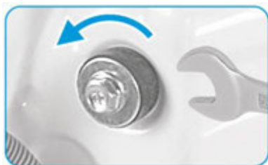
Ослабьте 4 транспортировочных болта
