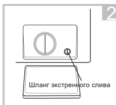
Поверните блокиратор на 90 ° и вытащите аварийный сливной шланг.
