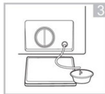
После того, как вода закончится, установите сливной шланг на место
