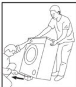
Внимание: Данный прибор тяжелый. Снимите пенопластовый уплотнитель, как показано на рисунке. Будьте осторожны, чтобы во время этой процедуры Ваша рука не попала под прибор.
