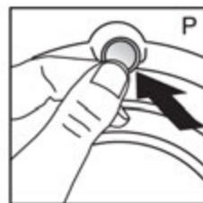
Вставьте пластиковые заглушки, поставляемые в комплекте с руководством, в отверстия на задней панели прибора. (P)
