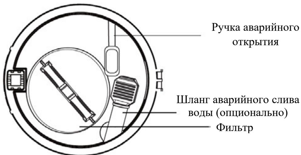
**Предупреждение:** Прежде чем открывать загрузочную дверцу, убедитесь, что внутри машины не осталось воды, чтобы предотвратить ее перелив.
