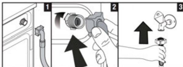
1. Подсоедините специальный шланг, поставляемый вместе со стиральной машиной, к впускному отверстию для воды.
