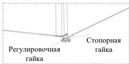
Ослабьте стопорные гайки на ножках с помощью гаечного ключа. Отрегулируйте ножки до тех пор, пока изделие не встанет ровно и сбалансировано.
