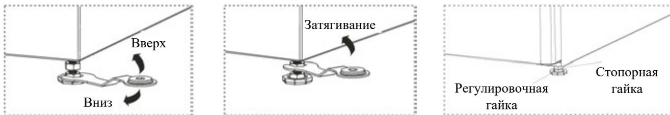
Ослабьте стопорные гайки на ножках с помощью гаечного ключа. Отрегулируйте ножки до тех пор, пока изделие не встанет ровно и сбалансировано.
