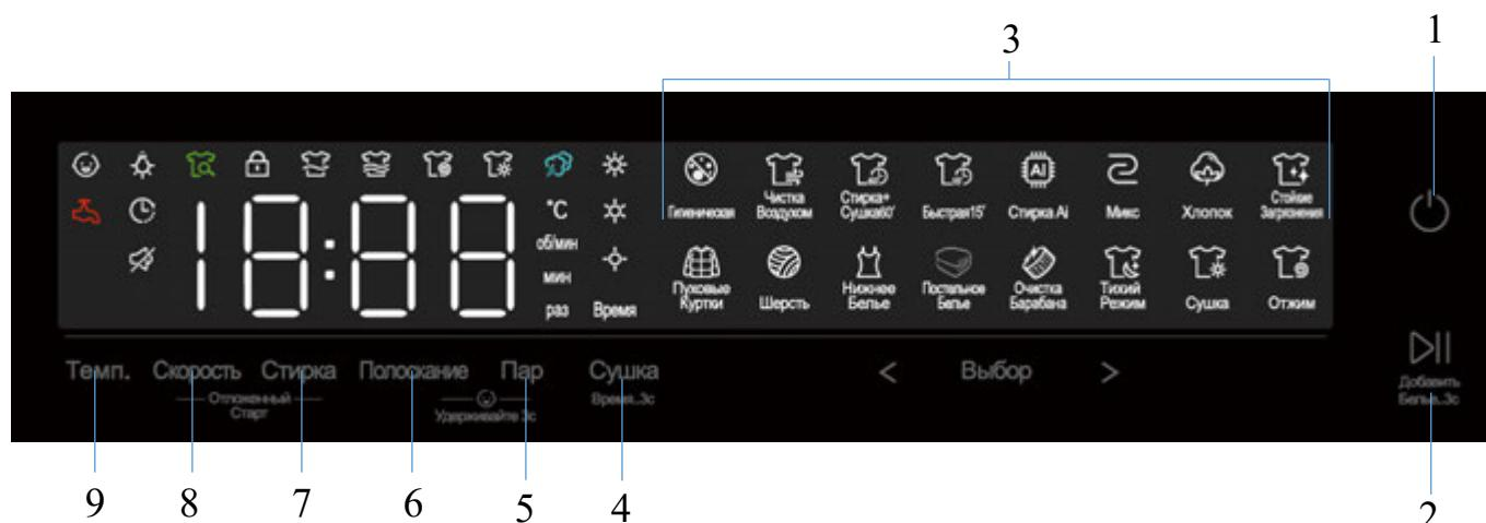
1. **Кнопка Вкл./Выкл.** – нажмите, чтобы включить или выключить устройство.
